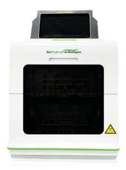
Permite la extracción automática de ácido nucleico de **64 muestras** como máximo en una sola vez.
